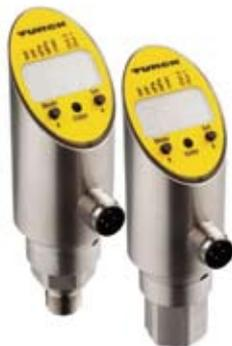
了高 EMC 等级以及全量程 0.5% 的测量精度。PS300 传感器过程连接方式包含了 G1/4" 内外螺纹，NPT1/4" 内外螺纹以及 R1/4" 螺纹方式，输出方式有数字量以及电流或电压模拟量。带金属密封圈，保证了可靠的过程连接，新系列的压力传感器带有 IO-Link 协议标准以及按照客户要求设计的 VDMA 菜单结构。
